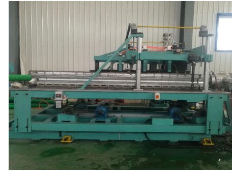
4.成型机SBCJ-315型（带有自动润滑系统） 1台 forming machine (with auto lubrication system) 1pc
